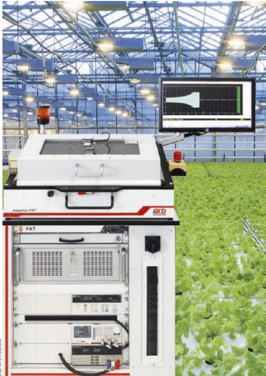
Teststation mit Adapter für Prüfling und Monitor. Der Bildschirm zeigt das Oszillogramm des Zündimpulses für die Lampe.
