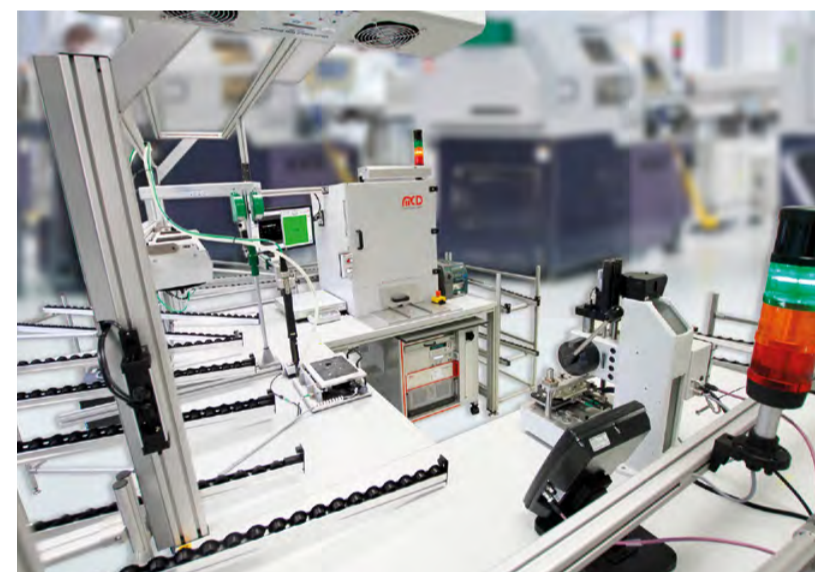
Im Vordergrund rechts die Handpresse für die Montage der Panels, in der Mitte die Station für die Endmontage des Steuergeräts, im Hintergrund die Prüfzelle für die optische und elektrische Prüfung.
