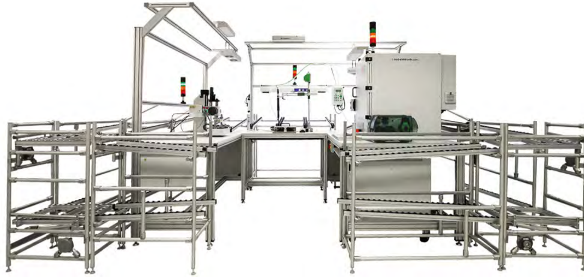
An diesem Arbeitsplatz montiert ein Mitarbeiter Steuergeräte und Panels von Lkw-Klimaanlagen und testet sie.
