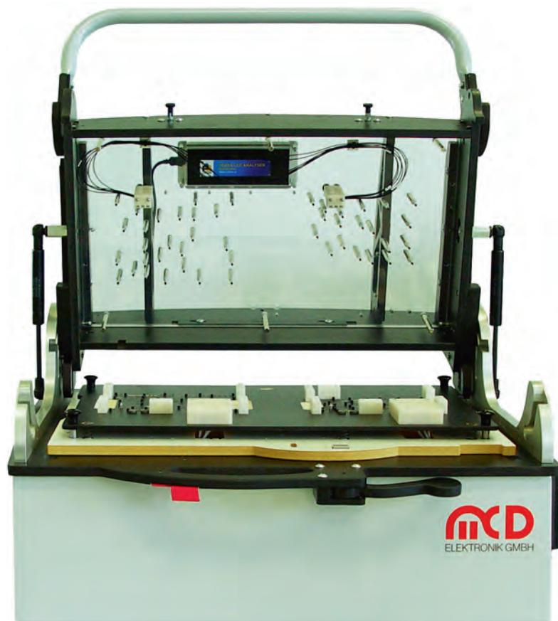
**BILD 1** Die erste Teststation ist vorbereitet zur Aufnahme von zwei Baugruppengrößen; über ein Nadelbett werden die Leiterplatten kontaktiert; die Lichtwellenleiter zur Überprüfung der LED-Anzeigen sind oben im Bild zu sehen
