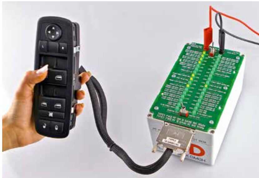
Bild 4: Manuelle Testboxen ermöglichen Tests am eingebauten Schalter.
