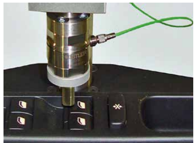
Bild 1: Der Prüf-Finger: Haptikprüfung mit Präzisions Servo Antrieb.
