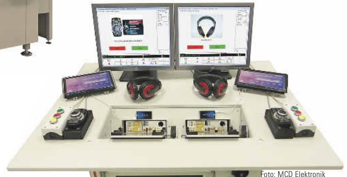
Die Station „Manueller Funktionstest“ mit zwei Bedienplätzen.
