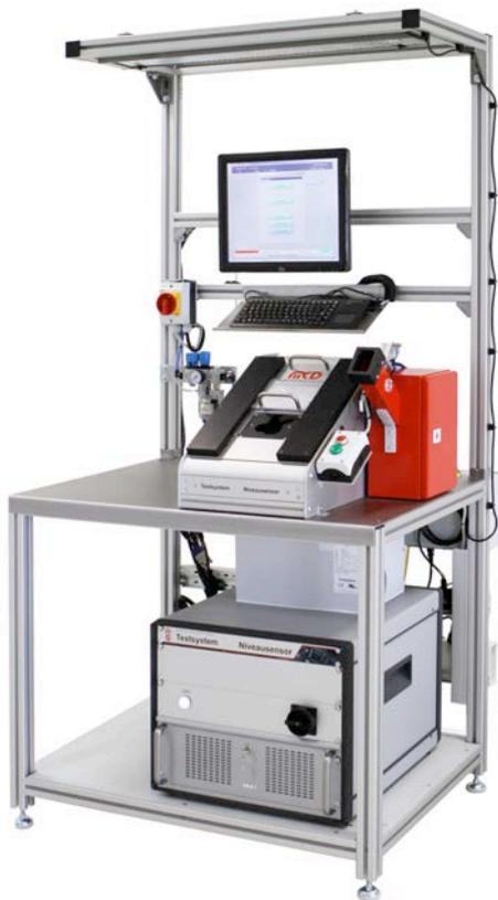
Bild: Das Testsystem von MCD Elektronik ist für die Programmierung und Überprüfung von Hall-Sensoren ausgelegt und liefert eine Fülle unverzichtbarer Daten für QS und Langzeitdokumentation.
