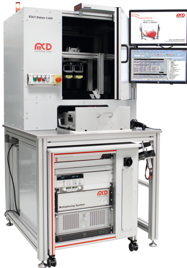
Bild 1: Die optische Prüfstation MCD Cognex Vision mit Einblick in den geöffneten Kameraraum.
