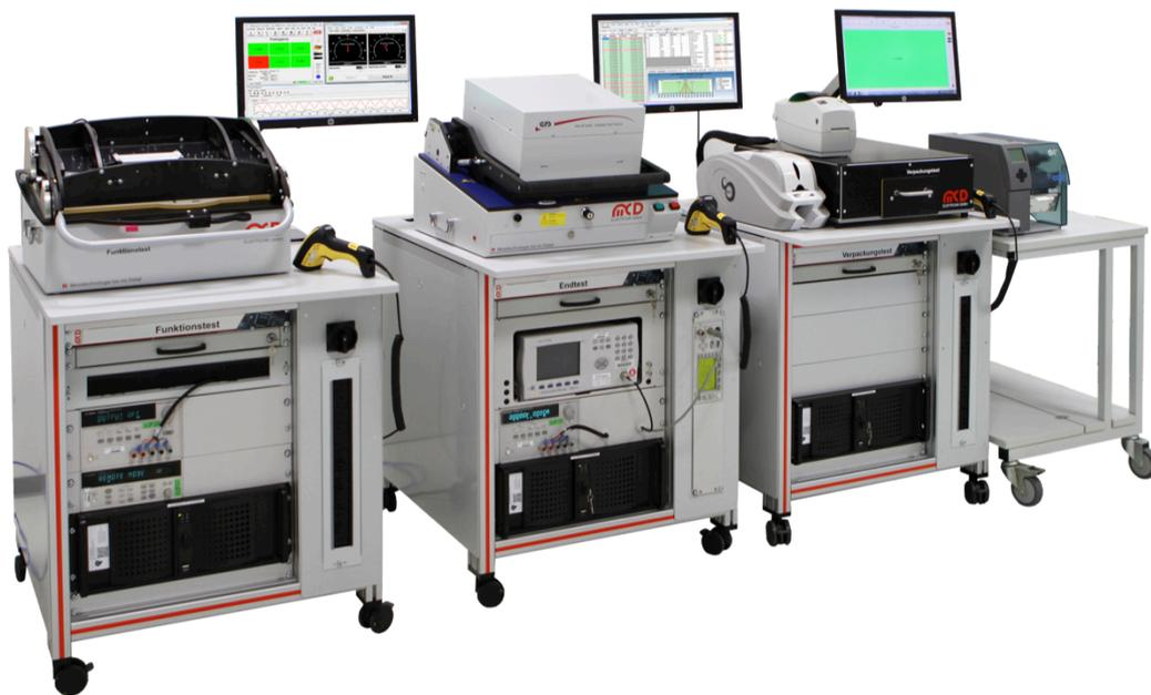
Bild 1: Die komplette Testlinie für den Produktionstest von mobilen WLAN Hotspots.
