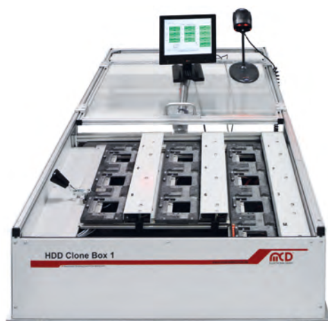
Bild 3: Die neue Desktop Clone Box zum Einlegen der HDD Festplatten.
