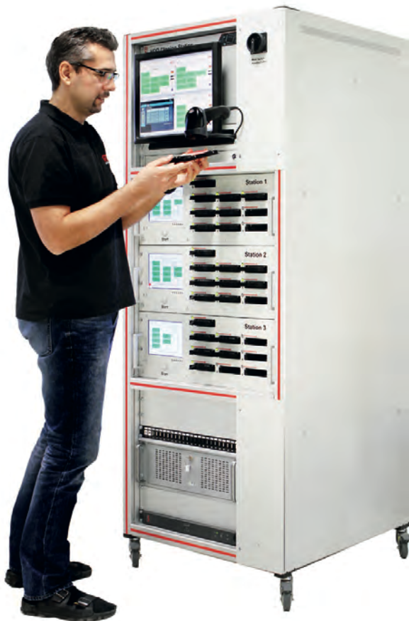
Bild 1: Die HDD Clone Station in der platzsparenden Rack-Variante. Über den Barcodeleser werden die HDDs erkannt und können fehlerfrei in die richtige Position gebracht werden.
